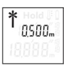
Снова нажмите выключатель **(1)**, чтобы опять включить лазер. Символ лазера
